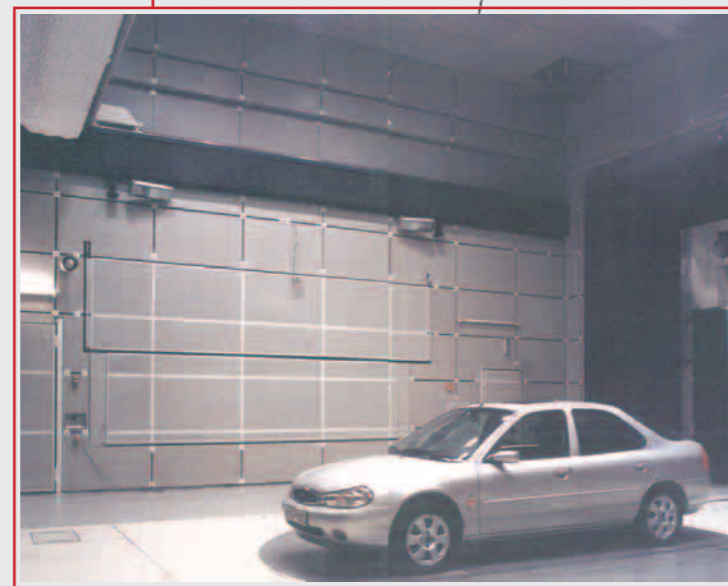
Windkanalplenum, ausgekleidet mit unserem CAR-System (bei geschlossenem Beobachtungsfenster)
