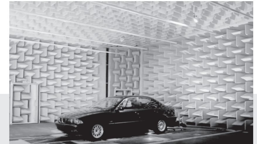
Semi-reflexionsarmer Messraum mit Fahrzeug-Rollprüfstand
