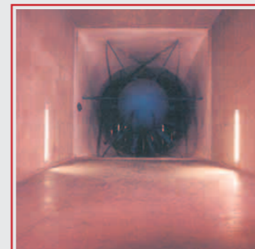
Gebläse mit akustisch und strömungstechnisch wirksamer An- und Abströmseite aerodynamic and acoustic specially designed air fan
