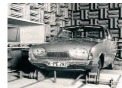
Semi-reflexionsarmer Schallmessraum mit Keilsystem, Entwicklungsstand um 1970.
