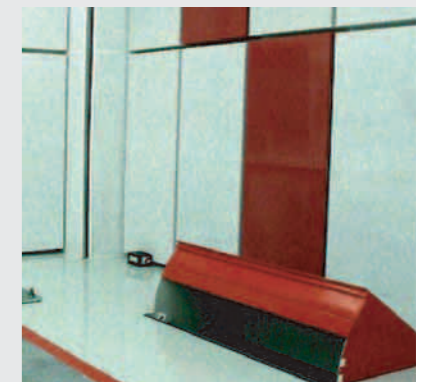
Automatisch versenkbare schallabsorbierende Umlenkklappe zur Kühlung des Fahrzeugs Automatic adjustable head wind flap for vehicle cooling
