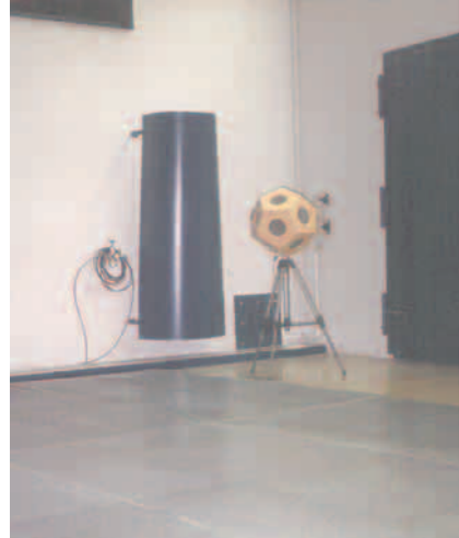
druckdichter Hallraum pressure-tight reverberation chamber
