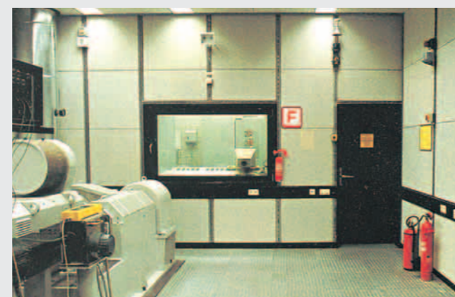
Prüfstand mit schalldämmendem Beobachtungsfenster Test stand with sound retardant observer window
