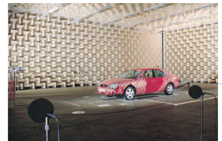
Moderner Freifeldraum zur Bestimmung der Vorbeifahrtgeräusche eines Pkw mit neu entwickeltem Keilsystem.
