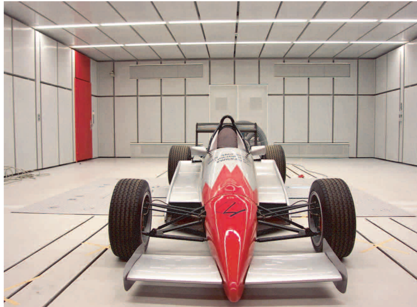
Semi-reflexionsarmer Raum mit Rollprüfstand für Forschungsaufgaben einer Universität, CAR-System, f_0 = 40\text{Hz}
